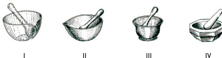
Figura 1: I - almofariz de vidro; II - almofariz de porcelana; III - almofariz de metal; almofariz de IV - ágata.
